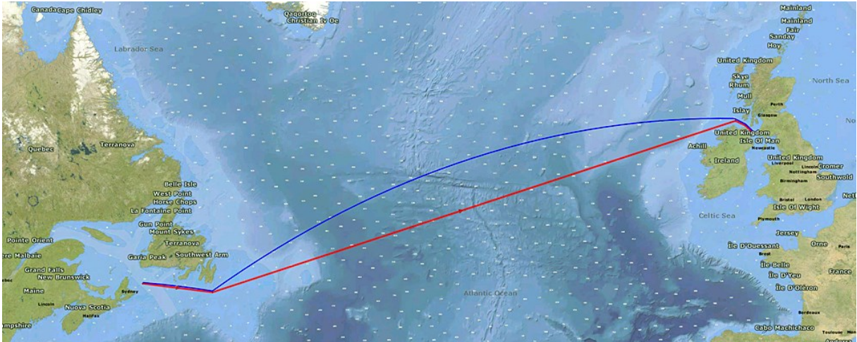
Routenberechnung im Vergleich. Rot: Loxodrome (länger), Blau: Orthodrome (kürzer).
